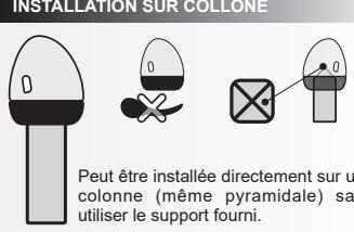
Peut être installée directement sur une colonne (même pyramidale) sans utiliser le support fourni.
